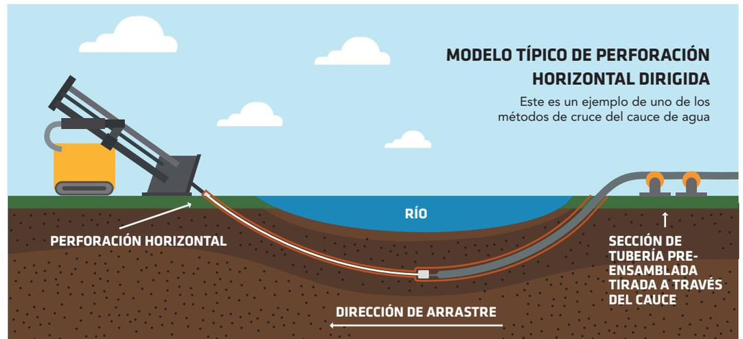
Figura 1. Esquema de instalación de tubería PEAD empleando perforación horizontal.
